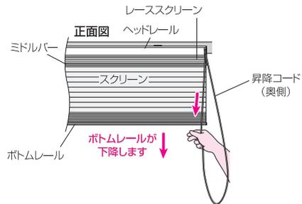
奥のコードを持って引き下げれば、スクリーンが下降し、手を止めればスクリーンが止まります。
