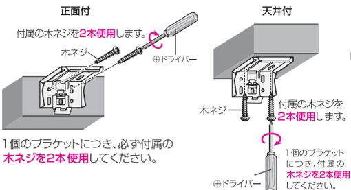
**△注意** 全てのブラケットが直線上で水平に確実に取り付けられているか、再度ご確認ください。
