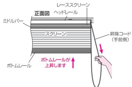
手前のコードを持って引き下げれば、スクリーンが上昇し、手を止めればスクリーンが止まります。
