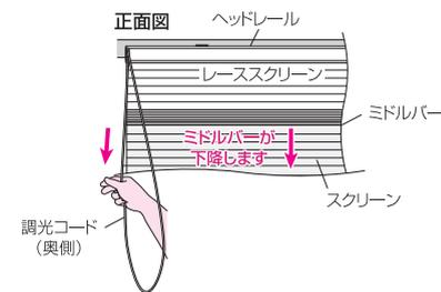
奥のコードを持って引き下げれば、レーススクリーンが下降し、手を止めればレーススクリーンが止まります。
