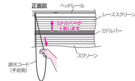
手前のコードを持って引き下げれば、レーススクリーンが上昇し、手を止めればレーススクリーンが止まります。
