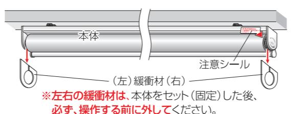
※左右の緩衝材は、本体をセット(固定)した後、必ず、操作する前に外してください。
