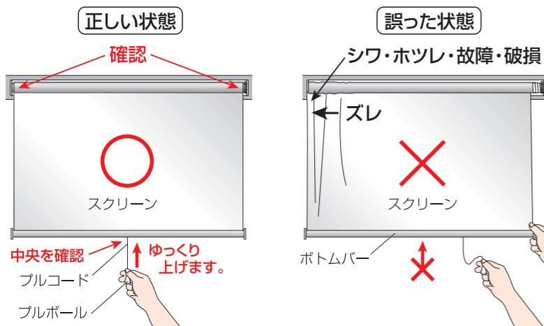
※取付場所が水平でない時やブルコードが中央にない状態又は、ボトムバーやスクリーンを持って操作しますとスクリーンを巻き上げた時、巻きズレが起こります。スクリーンにシワやホツレが発生し、本体の故障、破損の原因になる恐れがあります。巻きズレが起きた時は、ブルコードが中央にあることを確認した後、必ずブルボールを持ってスクリーンを下げ、ズレを直しながら、ゆっくりと上昇させてください。
