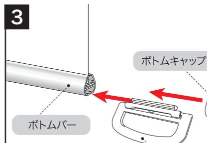
ボトムバーにハンドルをスライドさせ中央にセットし、ボトムキャップを付けてください。
