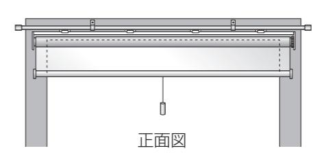
取り付ける前にカーテンレールの水平と強度を必ず、確認してください。
