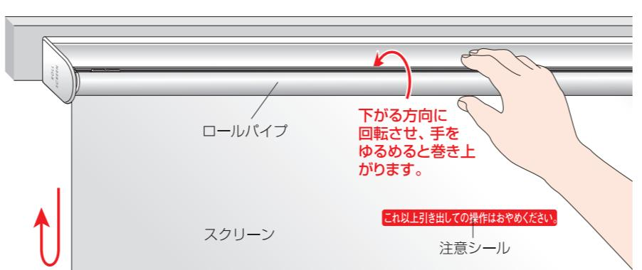
△注意 ストップが解除されると急激に巻き上がり思わずケガや事故の原因になりますので、ストップの解除が確認されたら必ず止めてブルボールを持って操作してください。
