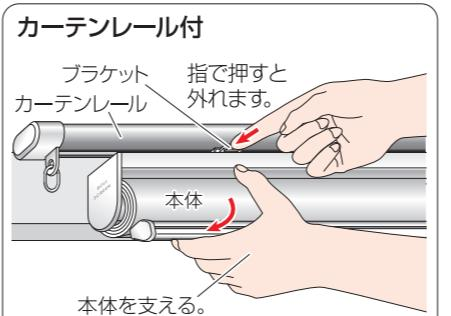
△注意 本体をブラケットから外す時は、本体が落下しないように支えた手を離さないでください。ブラケットから外している途中で支えた手を離すと落下、破損の原因になります。本体の取付後は、取り外す時以外、ブラケットのプラスチックの突起部分に触れないでください。触ると本体が外れ、落下の原因になります。
